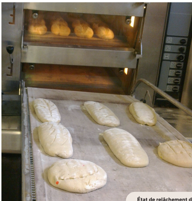
État de relâchement de la pâte après scarification. Source : INRAE.
